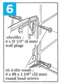
Pour une installation visée, marquer les trous à l'aide de la plaque de montage et percer le mur avec un foret de Ø 1/4" (6mm). Utiliser les 4 vis.
